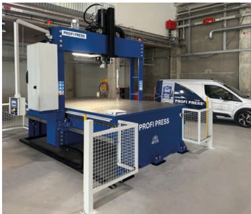
Custom-Made PPTLM-160 with 1000 mm piston stroke Sonderanfertigung PPTLM-160 mit 1000 mm Kolbenhub PPTLM-160 sur mesure avec course du vérin de 1000 mm PPTLM-160 hecho a medida con carrera del cilindro de 1000 mm
