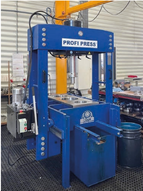
Custom-made Portal Press (160 Tn) with collection tray for axis Kundenspezifische Portalpresse (160 Tn) mit Auffangwanne für Achse Presse à portique sur mesure (160 Tn) avec plateau de récupération pour l'axe Prensa de pórtico a medida (160 Tn) con bandeja de recuperación para el eje
