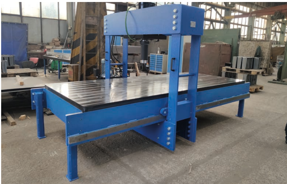
Portal Press (160 Tn) with a bigger table (3500 x 1500 mm) and flat table plate Portalpresse (160 Tn) mit größerem Tisch (3500 x 1500 mm) und flacher Tischplatte Presse à portique (160 Tn) avec une table plus grande (3500 x 1500 mm) et un plateau Prensa de pórtico (160 Tn) con mesa más grande (3500 x 1500 mm) y placa de mesa plana
