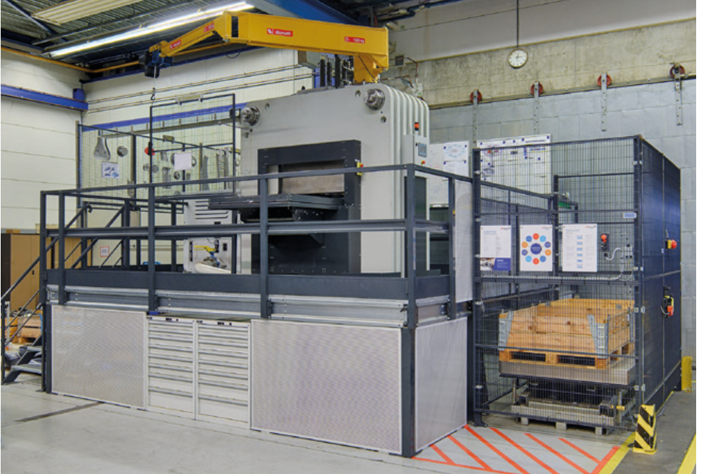
Custom-Made Press (2000 ton) | Kundenspezifische Presse (2000 Tonnen) | Presse Sur Mesure (2000 tonnes) | Prensa a medida (2000 toneladas)
