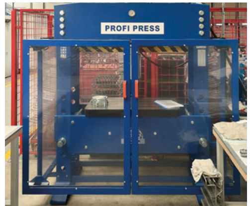
Workshop press with polycarbonate protection screens Werkstattpresse mit Polycarbonat- Schutzgitter Presse d'atelier avec écrans de protection en polycarbonate Prensa de taller con pantallas de protección de polycarbonato
