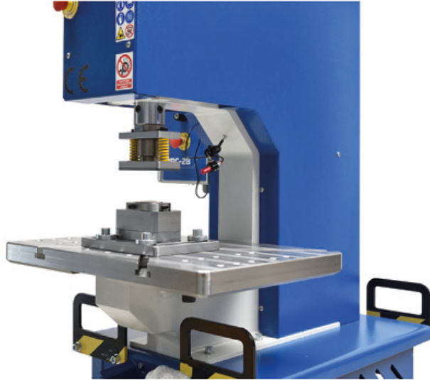
PPC-28 with special tooling and laser PPC-28 mit Sonderwerkzeug und Laser PPC-28 avec outils spéciaux et laser PPC-28 con herramientas especiales y láser
